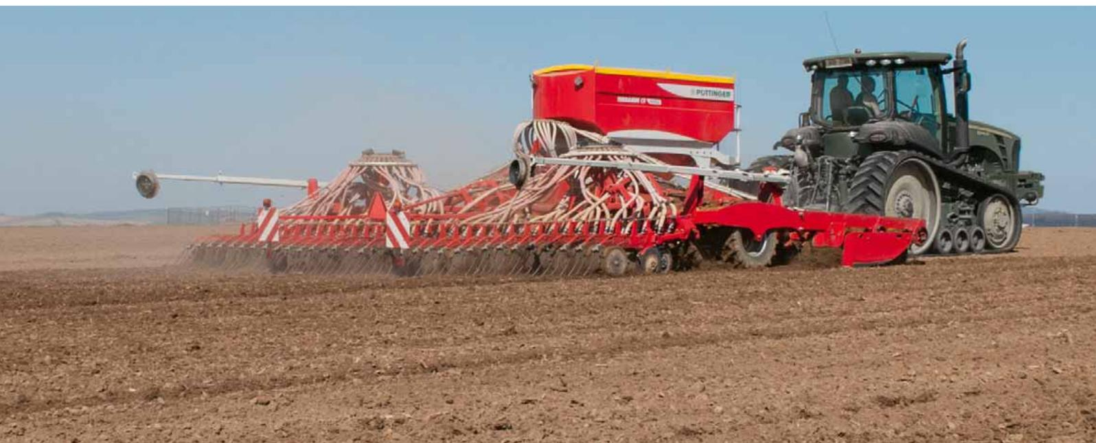
La TERRASEM di PÖTTINGER unisce diversi processi di lavoro quali lavorazione del terreno, compattazione e semina in una sola macchina. L'efficace erpice a dischi, il packer gommato unico nel suo genere e la perfetta barra di semina garantiscono una lavorazione ottimale.
