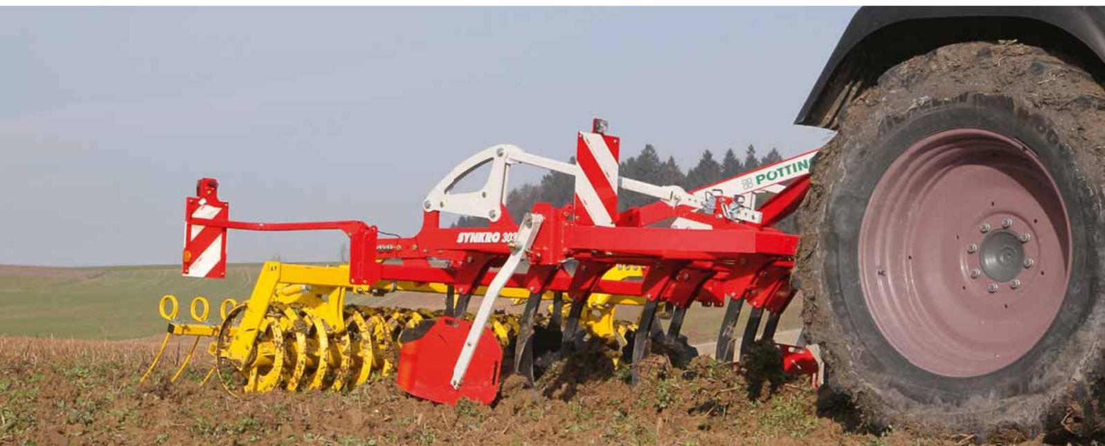
I coltivatori SYNKRO di PÖTTINGER sono stati ideati per l'abbattimento delle stoppie e sono adatti sia per la lavorazione del terreno in superficie che per quella in profondità. Nella costruzione si è data particolare importanza alla trainabilità e ad una potenza richiesta ridotta.
