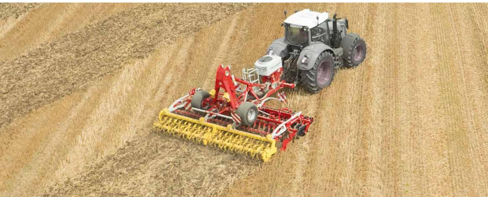
La seminatrice PÖTTINGER per colture intercalari combina lavorazione del terreno e semina di colture intercalari in un'unica fase di lavoro, riducendo tempi di lavorazione e costi. TEGOSEM è combinabile sia con gli erpici a dischi TERRADISC di PÖTTINGER, che con i coltivatori SYNKRO. L'impiego della seminatrice è possibile con macchine con attacco a 3 punti e con macchine semiportate.
