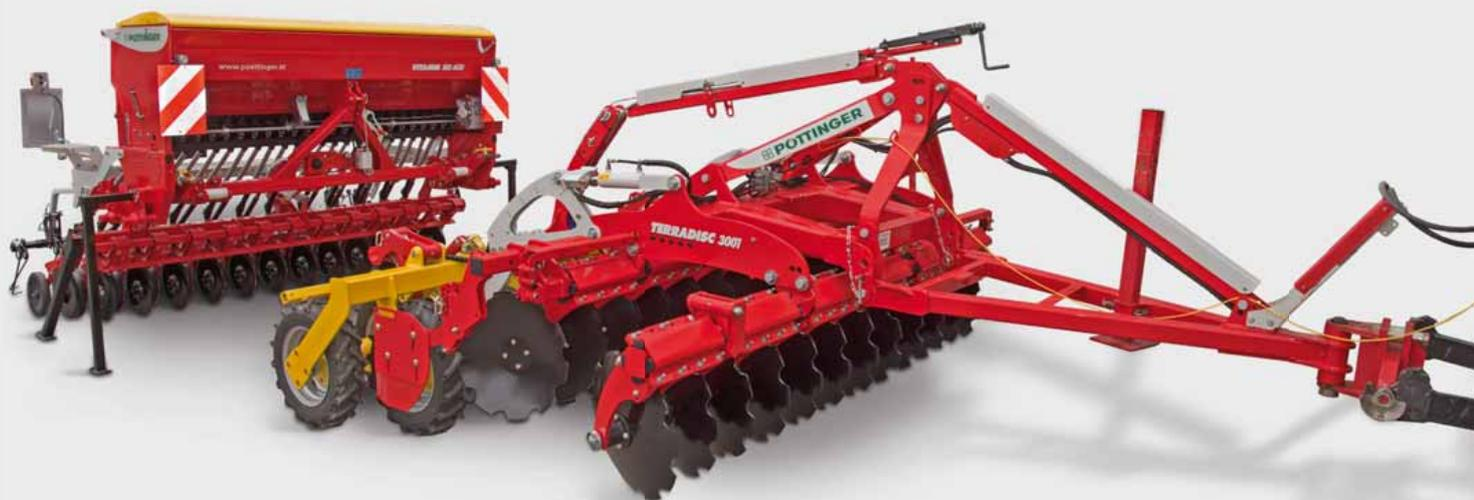
Dall'abbattimento delle stoppie alla semina su paccime con seminatrici per combine VITASEM ADD o AEROSEM ADD. In pochi minuti dalla combinazione di un erpice a dischi semiportato TERRADISC o di un coltivatore semiportato SYNKRO con una seminatrice VITASEM ADD o AEROSEM ADD risulta un'efficiente ed economica macchina per la semina su paccime.
