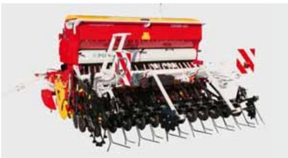
Навесные сеялки VITASEM A легко монтируются и демонтируются с почвообрабатывающих агрегатов. При работе в поле сеялка постоянно опирается непосредственно на каток.
