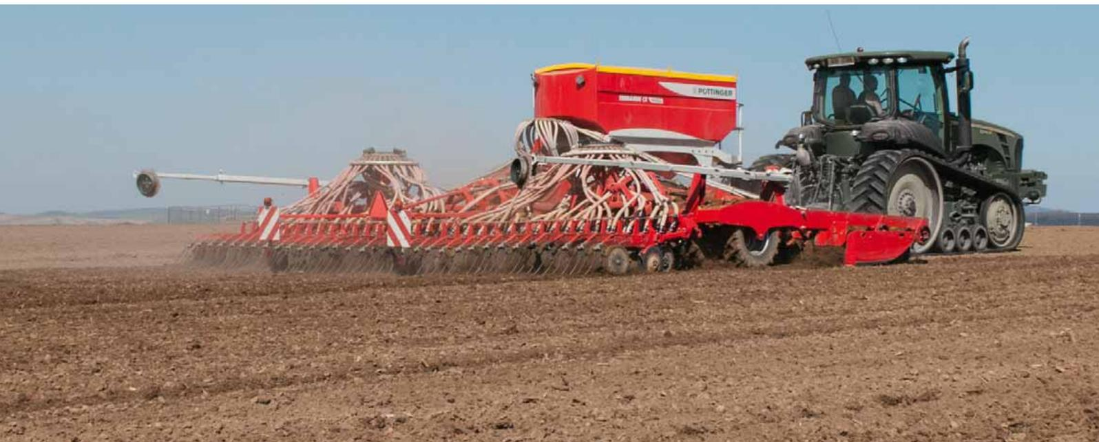
Концепция посева по мульче TERRASEM компании PÖTTINGER объединяет этапы обработки почвы, уплотнения и посева в одной машине. Эффективная короткобазовая дисковая борона, уникальный почвоуплотнитель и идеальные высевальные балки обеспечивают оптимальные результаты работы.
