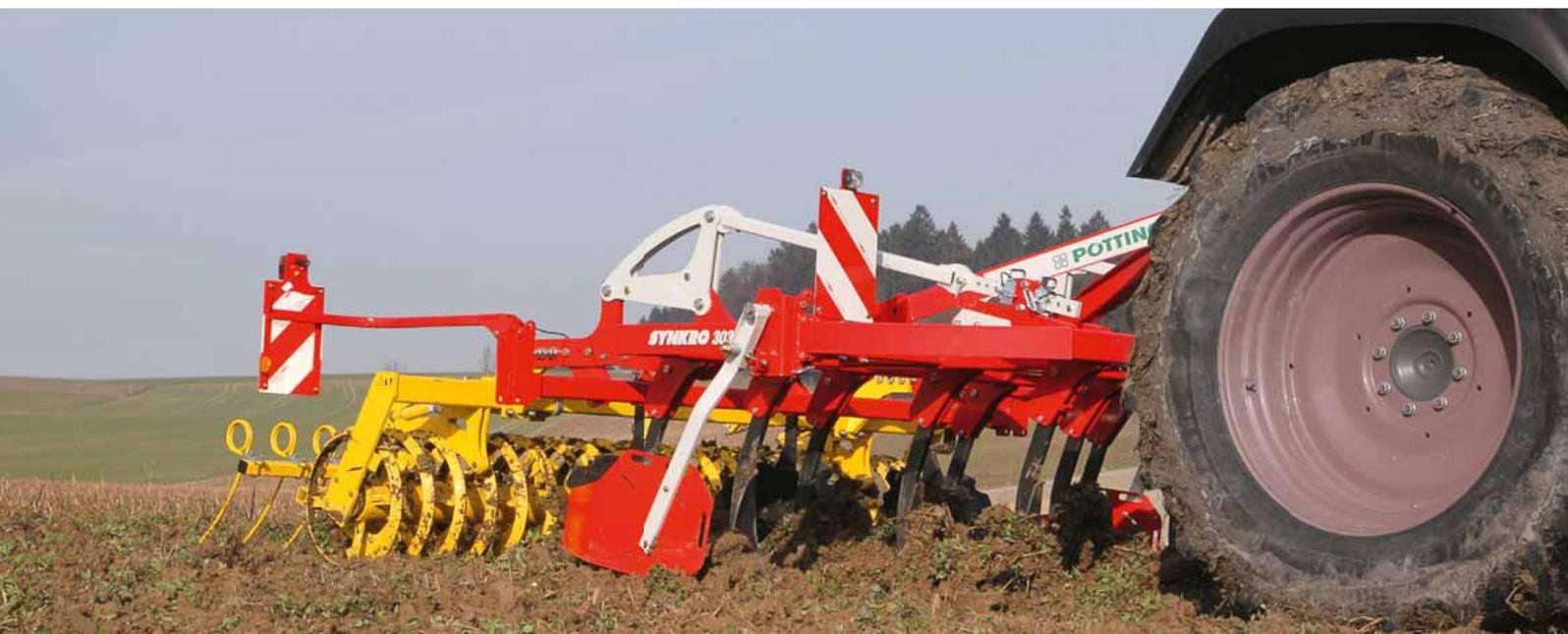
Культиваторы SYNKRO компании PÖTTINGER разработаны для своевременной обработки стерни и подходят как для поверхностной, так и для глубокой обработки почвы. При их конструировании особое внимание уделялось достижению легкости хода и низкой требуемой мощности.
