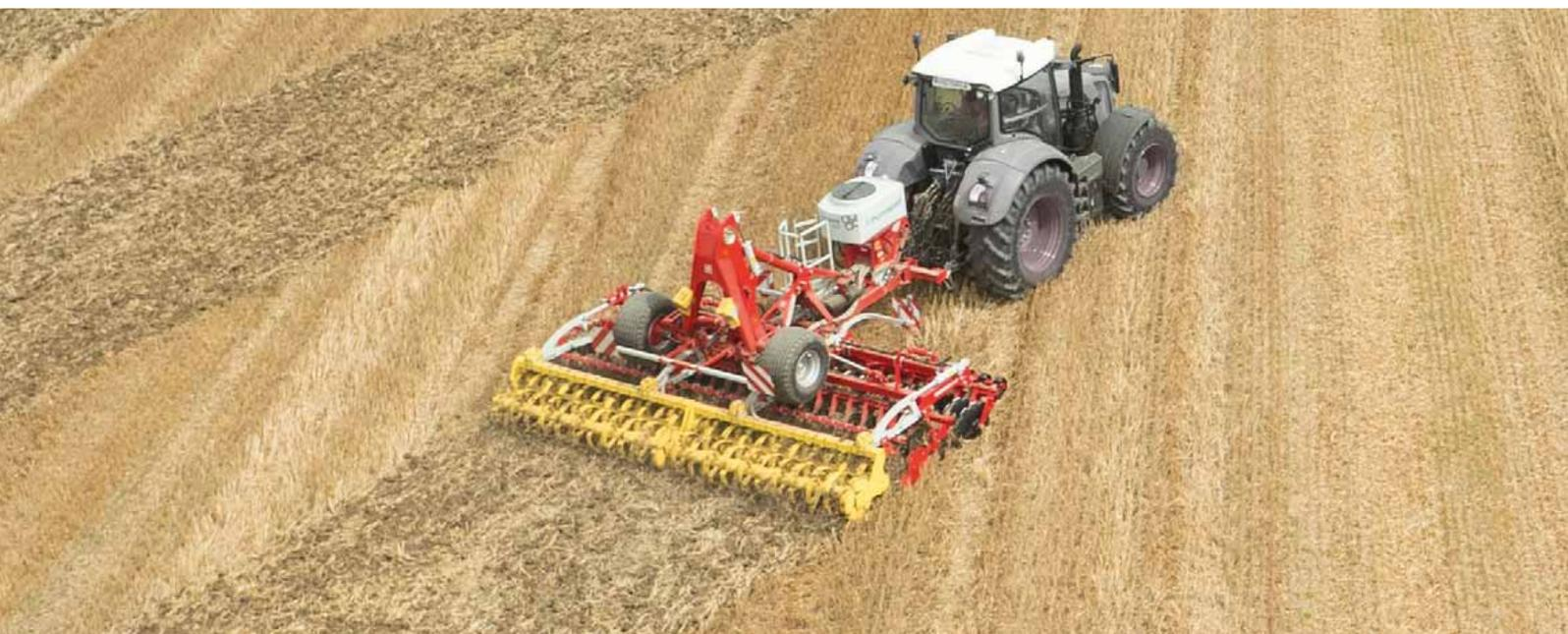
Сеялка TEGOSEM объединяет в одном рабочем шаге почвообработку и подсев трав, экономя тем самым время и деньги. TEGOSEM может работать как в комбинации с дисковыми боронами TERRADISC, так и с культиваторами SYNKRO. Сеялка может применяться на машинах с трехточечной навеской и на прицепных моделях.
