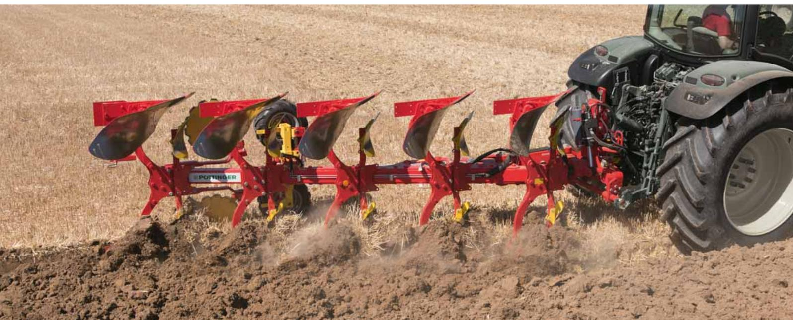
Прочная интеллектуальная конструкция плугов компании PÖTTINGER обеспечивает оптимальное распределение усилий и стойкость в местах максимальной нагрузки на раму. Уникальный центр регулировки PÖTTINGER позволяет легко и быстро приспособиться к любым видам почвы и условиям эксплуатации.
