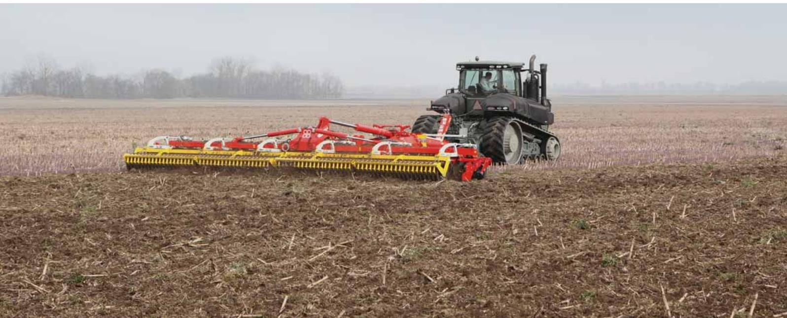
Короткобазовые дисковые бороны TERRADISC были разработаны для обработки стерни и общей предпосевной подготовки почвы. Компактная конструкция и агрессивное расположение дисков обеспечивают надежное вхождение в грунт и тщательное перемешивание пожнивных остатков.
