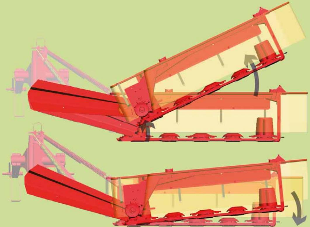
Am Vorgewende braucht das Traktorhubwerk nicht betätigt werden. Daher ist kein Nachjustieren nach dem Absenken nötig.
