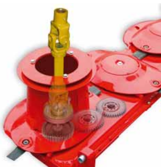
Dvojitý kloub ve vnitřním žacím bubínku zajišťuje spojení mezi úhlovým převodem a lištou bez pnutí.
