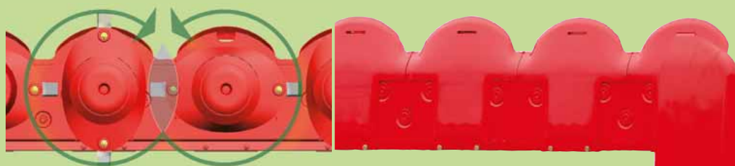
Čistý a rovnoměrný tvar pokosu díky optimalizovanému překrývání oběžných drah nožů
