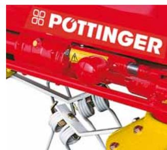
Hydraulische Schrägstellung serienmäßig bei HIT AZ über einen einfachwirkenden Hydraulikzylinder mit Gasspeicher.
