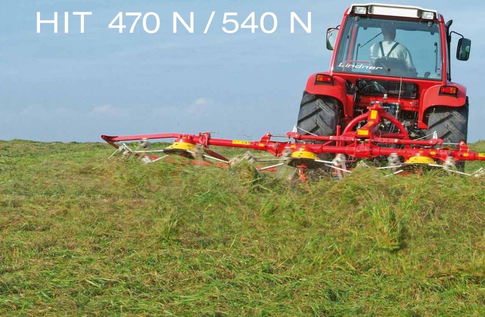
Die gehobenen Ansprüche der Klein- und Mittelbetriebe wurden im 4-Kreisel-Zetter verwirklicht. Konzipiert auch für extreme Hanglagen zeichnen die Zetter der kurze Anbaubock und der kleine Kreiseldurchmesser aus. Kompaktheit pur, Arbeitsbreiten von 4,0 bis 5,20 m (DIN).
