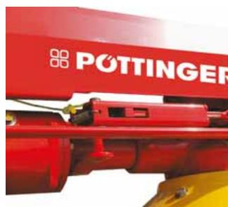
Mechanische Schrägstellung – HIT NZ – einfach über Seilzug vom Traktorsitz.
