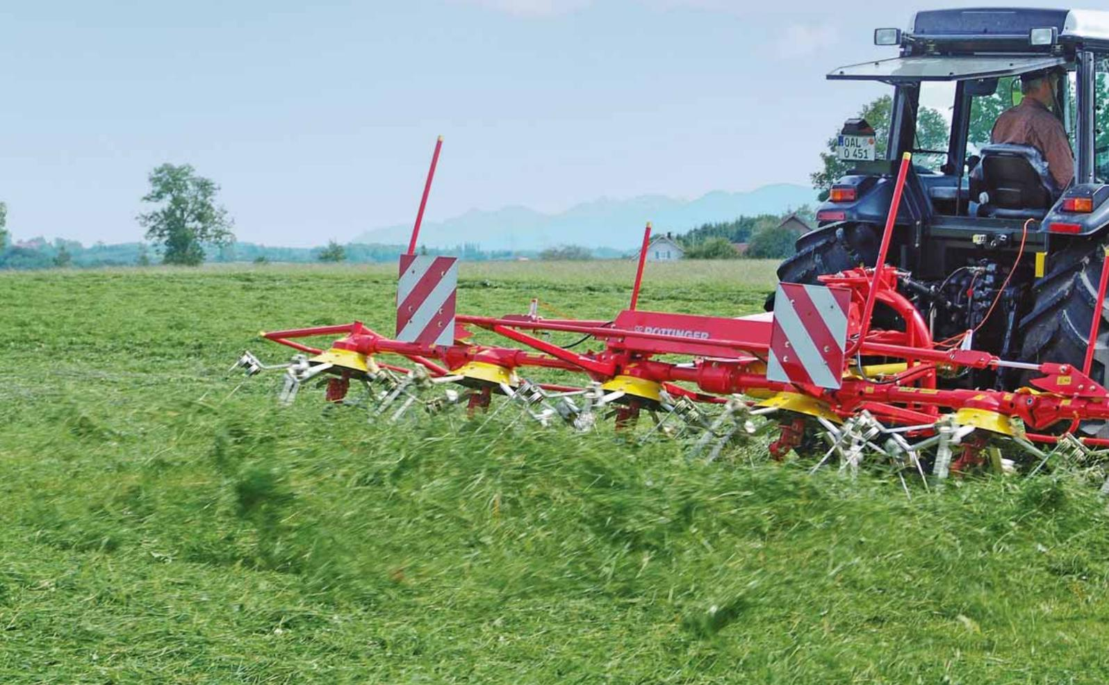
Die Zetter von Pöttinger sind für den kurzen Anbaubock bekannt. Dadurch verlagert sich der Schwerpunkt näher zum Traktor, der Hubkraftbedarf des Traktors wird gesenkt und die Fahr-sicherheit erhöht.
