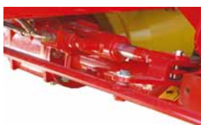
Hydraulické dvojčinné pro modely HIT AZ
