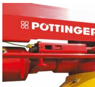
Mechanické nastavení šikmého směru kol – typy HIT NZ – snadno ovladatelné lanovodem přímo ze sedadla traktoru.
