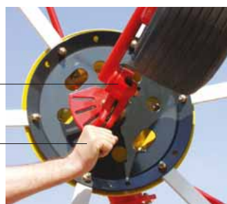
Ruční nastavení šikmého směru kol (HIT N a HIT A)
