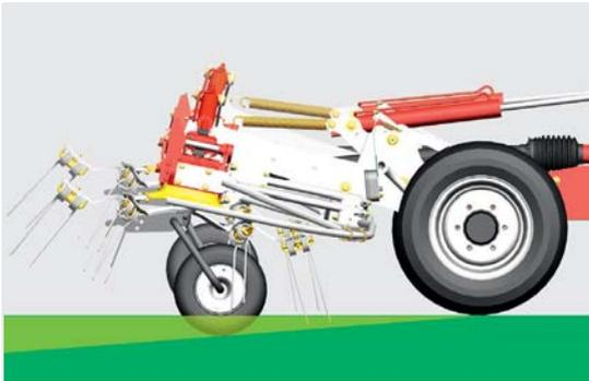
**Bei HIT 10.11 T und HIT 12.14 T sind alle Kreisel für perfekte Boden Anpassung mit Gelenken ausgestattet.**
