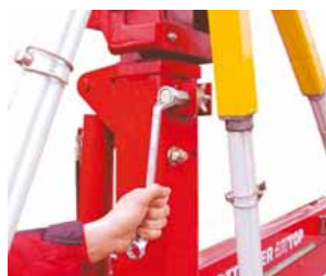
Nastavení se provádí mechanicky na ramenech rotoru.
