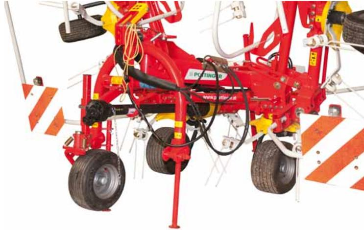
Der Oberlenker wird im Langloch des Anbaubockes gefahren. Das Tastrad führt die Zinken exakt über die Bodenkonturen. Die Arbeitshöhe ist durch das Rad immer richtig voreingestellt. Sie können schneller fahren und damit eine höhere Flächenleistung erzielen. Die Grasnarbe wird geschont und die Lebensdauer der Zinken verlängert.
