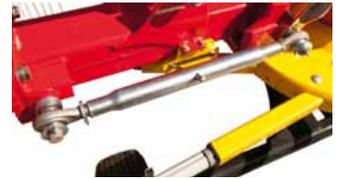
Arbeitsbreitenverstellung – lange Spindel
