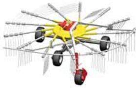
Dreirad-Fahrwerk mit Multitast-Rad
