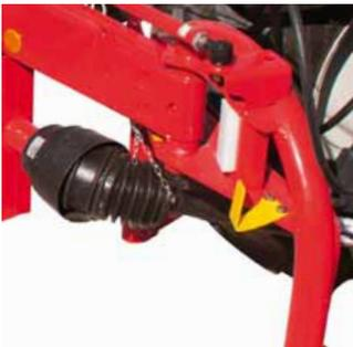
Lenkwinkel-Anzeige am Rohrbügel
