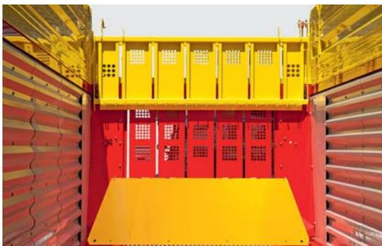
Die Ladeautomatik garantiert eine vollständige Befüllung und damit hohe Transportkapazitäten. Das Futter wird bereits im Förderkanal schonend verdichtet und der Laderaum zur Gänze genutzt. Standard bei FARO 4010 COMBILINE und FARO 8010.
