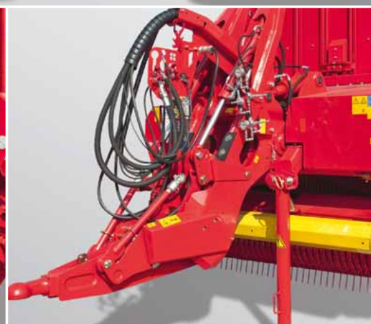
Дышло 4,0 т, низкорасположенное, принудительное управление
