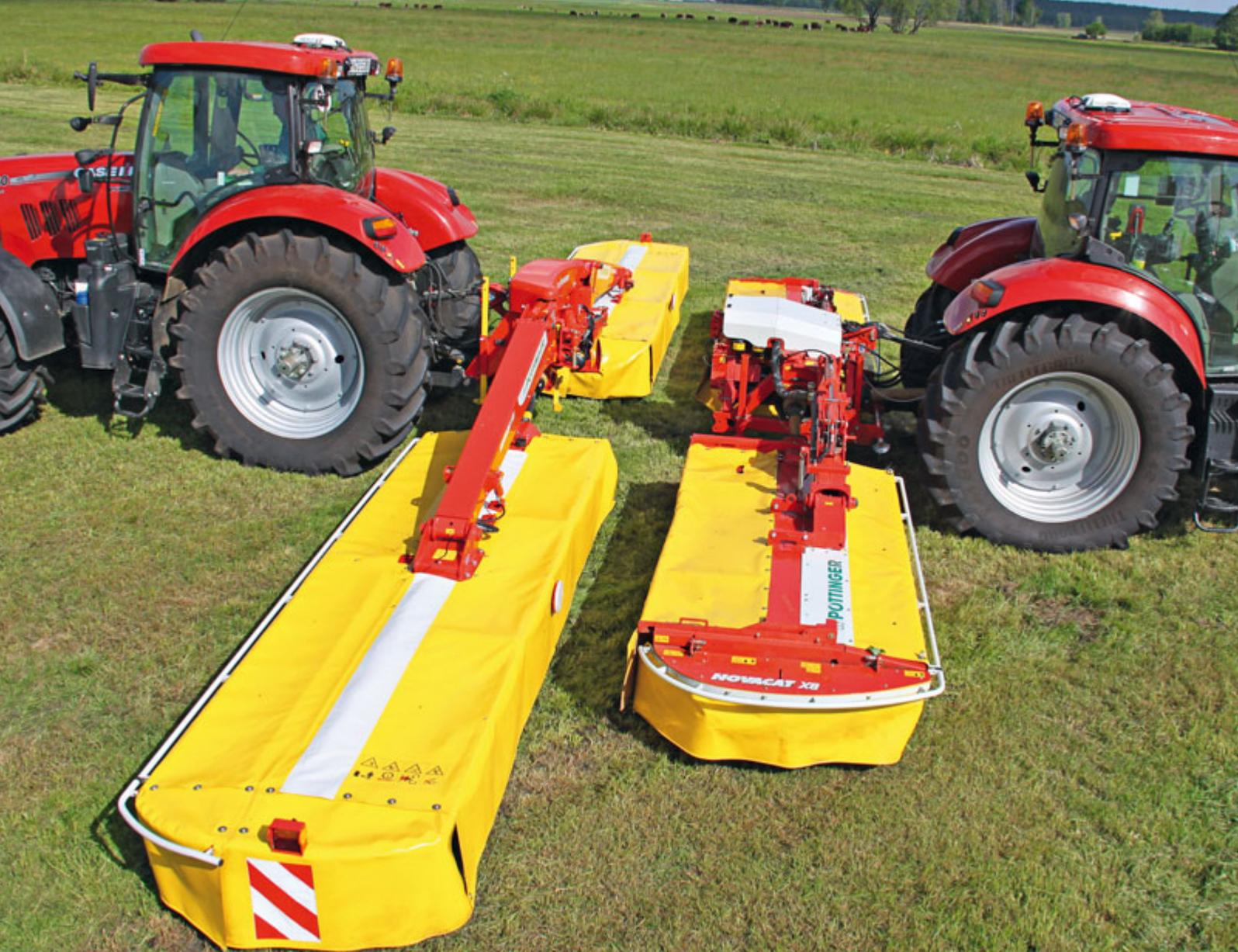
Die neue Kombination Novacat S12 arbeitet mit einfacher Technik bis zu 11,20 m breit. Im Vergleich musste sie gegen die Novacat X8 ran, diese bringt es auf 8,30 m Arbeitsbreite.
