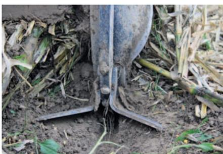
Mit der Kombination von Spitzschar und Flügelschar ist ein ganzflächiges Durchschneiden des Bodens möglich.
