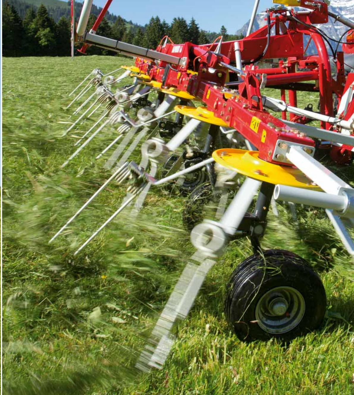
Das Besondere an diesen Alpinspezialisten ist die leichte Bauweise: Formrohr-Rahmen, Zinkenträger aus Federstahl und leichte Rohrbügel reduzieren das Gewicht, wobei die nötige Stabilität garantiert ist. Pöttinger ist es gelungen, bei einer Arbeitsbreite von 4,0 m DIN das Gewicht bei nur 245 kg (ALPINHIT 4.4 H) oder 270 kg (ALPINHIT 4.4 N) zu halten.
