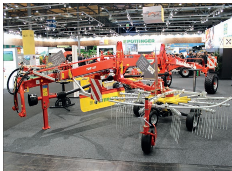
Nástupcem oblíbeného modelu Eurotop 651 je nový typ shrnovače TOP 662. Z pracovního záběru 6,55–7,3 m odkládá řádek do strany vpravo a dokáže se dobře přizpůsobit různým technologiím sklizeň i výnosům hmoty
