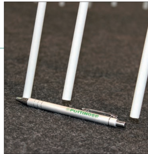
Nově firma Pöttinger u svých shrnovačů osazuje hrabice tak, že dva prsty na okraji mají menší délku. Díky tomu se zatížení v průběhu shrnování píce rozkládá na všechny prsty rovnoměrněji a tomu odpovídá i rovnoměrnější opotřebení
