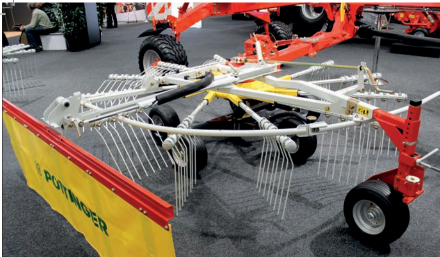
Pětikolový podvozek rotorů shrnovačů Pöttinger TOP je osazen ještě kolečkem za dráhou prstů, které spolupracuje s předsunutým kolečkem systému Multitast
