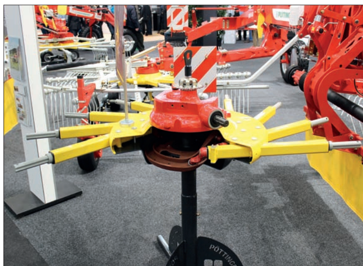
Nově vyvinuté rotory DuraTech dovolují snadné vyjmutí hrabice v případě, že by došlo nárazem na překážku k jejímu poškození. Uzavřená vodící dráha má velký průměr a vodící kladky jsou opatřeny bezúdržbovými samomaznými ložisky. Shrnovač má díky tomu klidný chod a působí na píci šetrně
