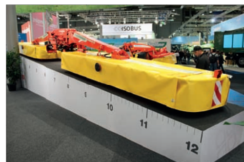
Největší žací kombinace na trhu NovaCat S12 váží jen o něco málo přes 2000 kg a pro agregaci požaduje traktor o výkonu 160 k. Elektrohydraulicky lze samostatně ovládat zdvih u každého stroje
