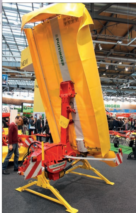
Žací stroj NovaCat 352 V není vybaven kondicionérem a k jeho pohonu postačuje traktor o výkonu 80 k. Písmeno „V“ na označení stroje poukazuje na novou možnost vertikální transportní polohy
