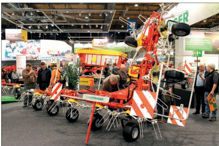
Hit 8.91 je nesený obrabeč s osmi novými rotory DynaTech. Ramena se zakřiveným tvarem jsou šetrná k pici, která se na nich zároveň ani nezachytává. Uchycené jsou v lisovaných rotorech se speciálním profilem
