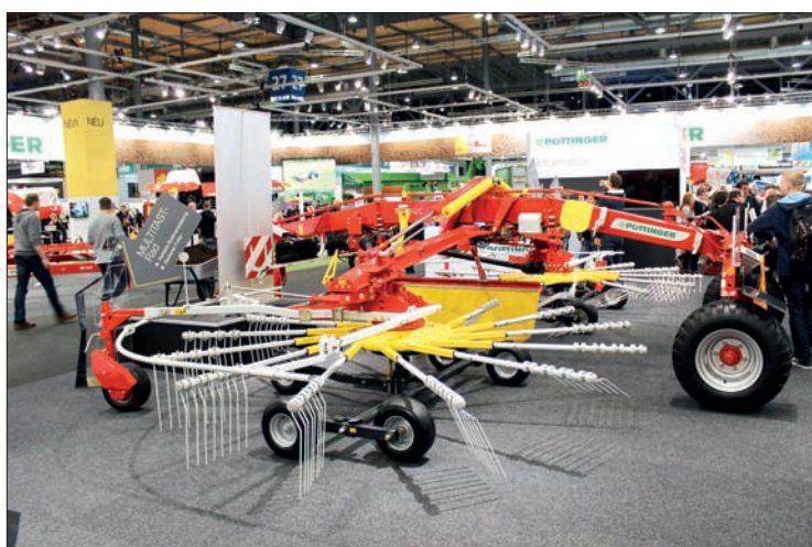
Dvourotorový shrnovač TOP 842 C je vhodným spojením velkého záběru, rovnoměrného středového formování řádku a obratnosti dané malou délkou a podvozkem s řízenou nápravou
