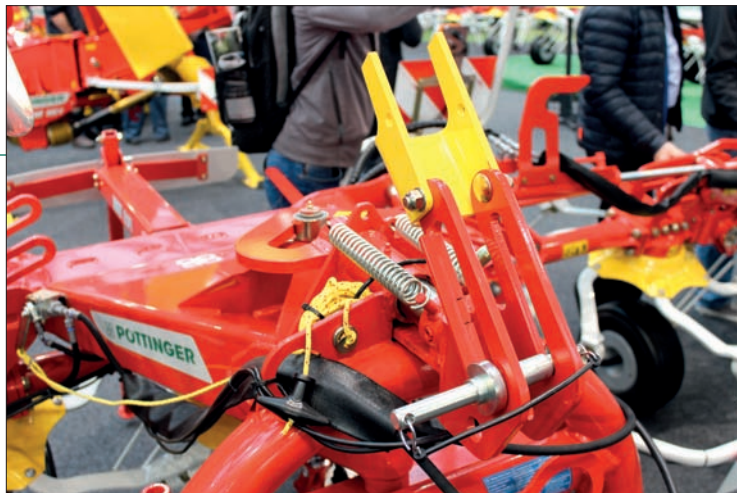
Nesené obrabeče firmy Pöttinger mají šikovně vyřešené zajištění pro přepravu. Namísto dřívějšího řetězu jsou vybavené tímto mechanickým zajištěním, které obsluha po skončení práce na pozemku sklopí a tím dojde k zafixování horního táhla v podélné kulise. Obrabeč se díky tomu nemůže kývat a lze jet s traktorem i vyšší rychlostí po nerovné cestě
