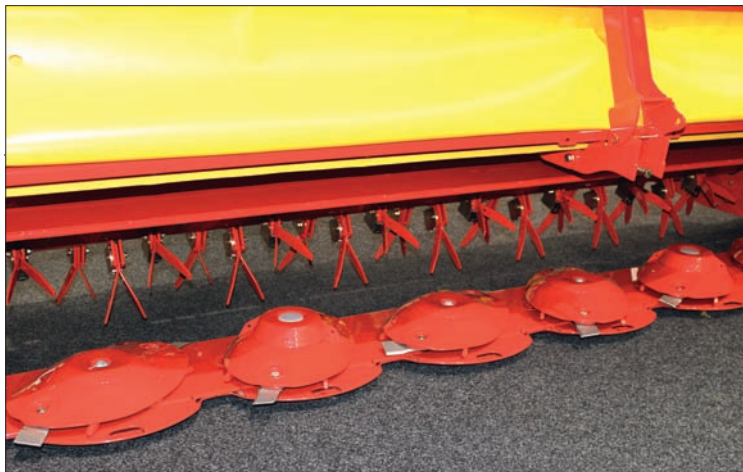
Žací nosník strojů NovaCat má inovovaný pohon – ozubená kola mají špičatější zuby, a v záběru jsou vždy tři z nich. Díky tomu se točivý moment může rovnoměrněji rozložit
