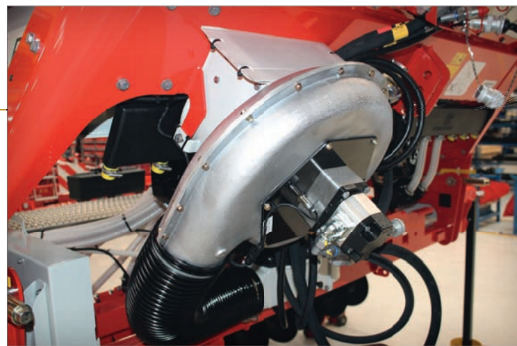
Výkonný ventilátor bude nově vybaven tubusem, díky kterému bude nasáván čistý vzduch z oblasti nad strojem. Při setí kukuřice s přihnojováním nebo s podsevem je proud vzduchu pomocí klapky rozdělován pro souběžný transport osiva i hnojiva nebo dvou druhů osiv
