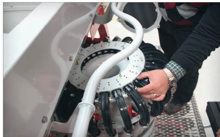
U standardní rozdělovací hlavice se uzavření semenovodů provádí po odšroubování krytu manuálně. Stačí jednoduše přepnout mechanické páčky do polohy zavřeno
