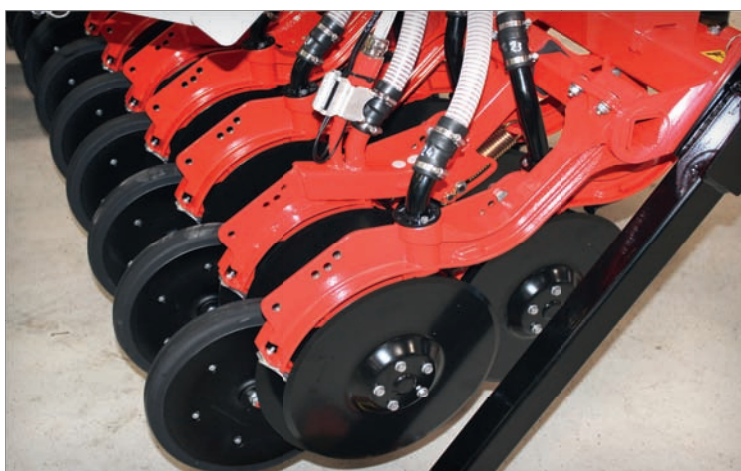
Secí botky pro výsev kukuřice jsou vybaveny optickým senzorem, který kontroluje procházející zrna. V případě odchylky vyšle upozornění
