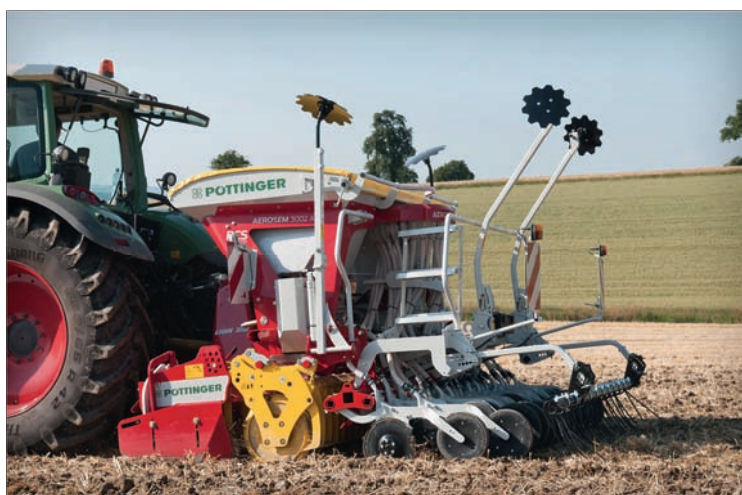
Ve výbavě s rozdělovací hlavicí IDS je možné provádět z kabiny nastavení rozteče kolejových mezířádků či jejich šířky podle potřeby. Toto pohodlí ocení každý uživatel zvláště při poskytování služeb
