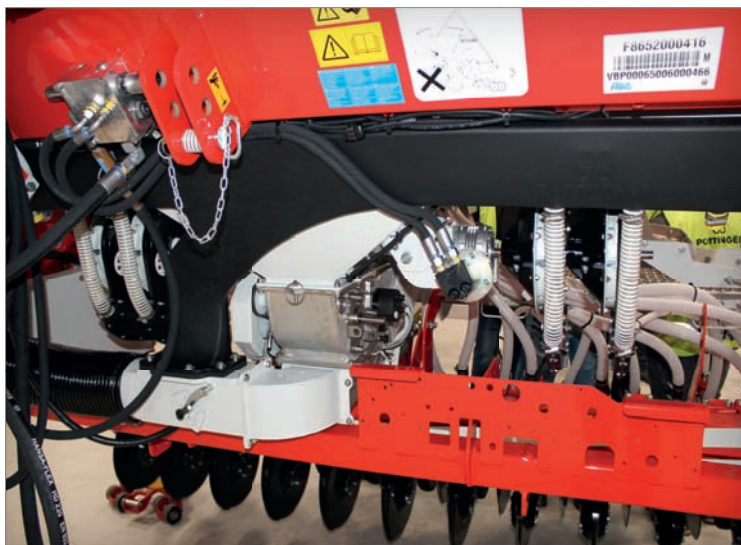
Secí stroj Aerosem 3002 má na levé a pravé straně po jednom přesném výsevním ústrojí PCS. Jejich pohon je společný od hydromotoru, poháněného prostřednictvím jednoho vnějšího okruhu hydrauliky traktoru
