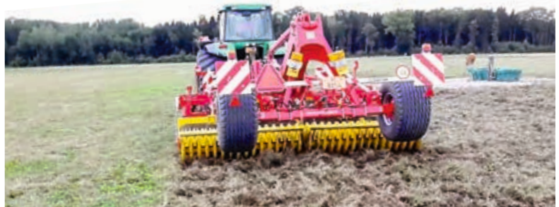
Der Grubber Synkro 4030 T von Pöttinger erweist sich als sehr wirksam, um die Wiese für die nächste Kultur vorzubereiten.
