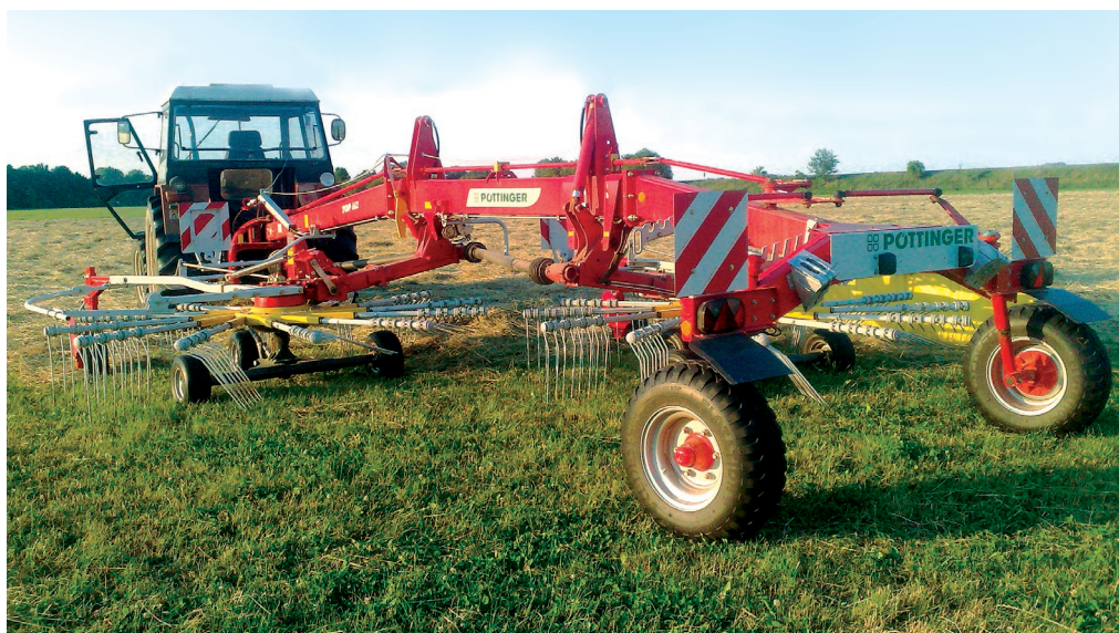
Roman Moudrý z Lomnice nad Lužnicí agreguje shrnovač TOP 662 s traktorem Zetor 7745. Předností stroje je i zadní řízená náprava, která zajišťuje nadjiždění stroje při otáčení na úvratích a manévrovatelnost při přejezdech.
