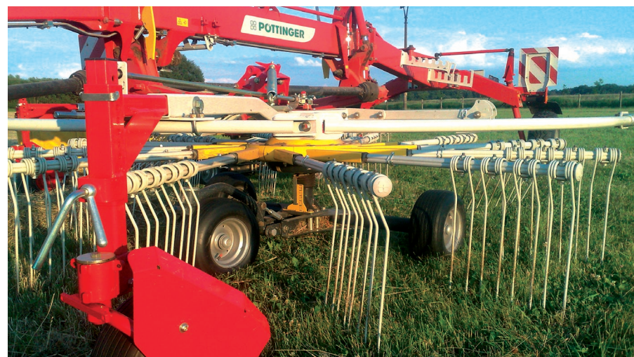
Čelní kopírovací kolečko s možností nastavení má výrazný vliv na snížení nečistot v pící a na prodloužení životnosti prstů. Kolečko kopíruje nerovnosti před rotorem a v těsné blízkosti prstů.
