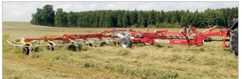
Hit 12.14 T umí zajistit i rozhoz či otočení píce velké výměry za ideálních podmínek. Je vybaven rotory s průměrem 1,42 m. Rotory jsou osazeny šesti rameny, které mají speciální zakřivený tvar a nedochází na nich k zachytávání píce
