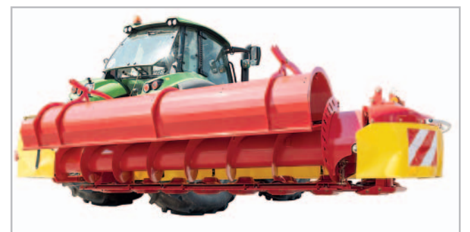
Jednoduchým zvednutím zadního krytu dopravníku je možné docílit toho, že je píce odkládána na široko. Po sklopení krytu posouvá dopravník veškerou hmotu ke středu soupravy, přičemž díky od sebe vzdáleným závitům má vysokou průchodnost
