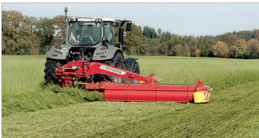
Žací stroj Pöttinger NovaCat 352 CF za sebou zanechává čistý pozemek se zdvojeným řádkem, na němž je uložena píce beze ztrát a bez znečištění
