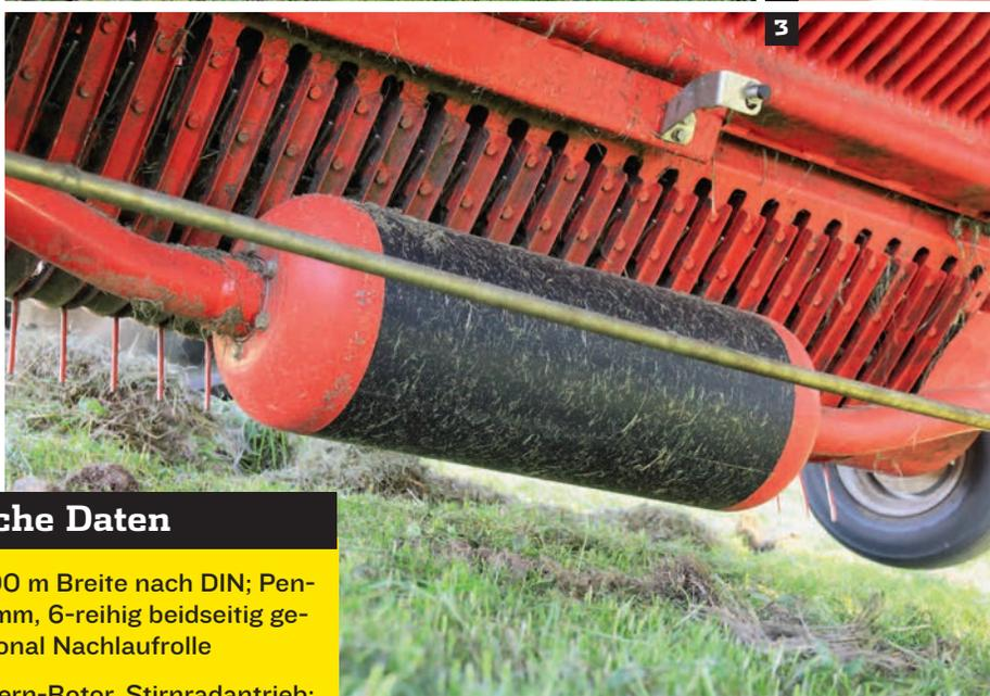
**1** Die Pickup besitzt 2,0 m Aufnahmebreite nach DIN. Über den Tasträdern ist die Hebelkinematik der Tastrolle zu sehen (nicht lackiert).
