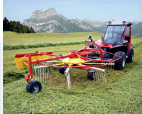
Het idee van het neustastwiel is gegroeid vanuit de geduwde AlpinTop-frontharken.
