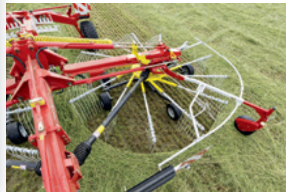
Het Multitast-wiel zit voor iedere rotor en zorgt ervoor dat de harkelementen de bodem precies volgen. Meegenomen is dat de tanden worden ontzien.
