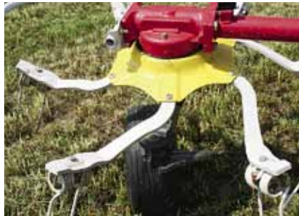
Die Kreiselsteller sind gepresst und nehmen die geschwungenen, schleppend angeordneten Zinken passgenau auf.
