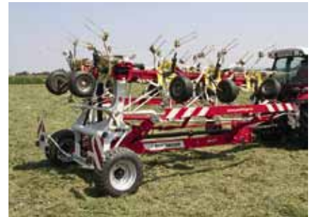
Der Hit 10.11 T hat eine kompakte Transportposition und läuft ordentlich hinter dem Schlepper her.
