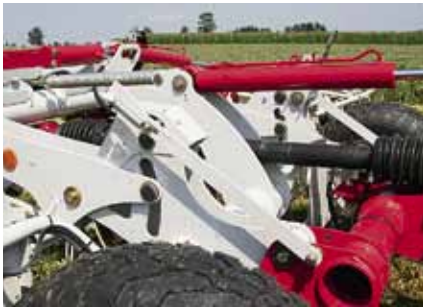
Die Kulisse erlaubt das zunächst waagerechte Ausheben und den anschließenden Schwenk nach oben am Vorgewende.
