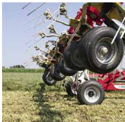
Die Aushubhöhe von rund 90 cm hat Pöttinger sehr großzügig bemessen.
