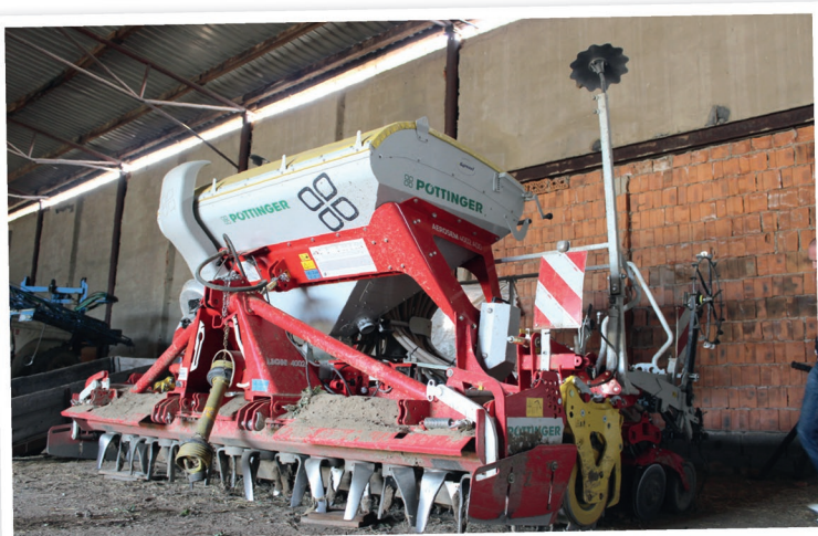
Secí kombinace firmy Pöttinger má nejenom vhodně zvolené uspořádání pro usazení těžiště v blízkosti traktoru, ale zároveň poskytuje obsluhu i snadný přístup k zásobníku osiva. Ten pojme jeden velkoobjemový vak, hmotnost osiva se přenáší na zubový packer válec
