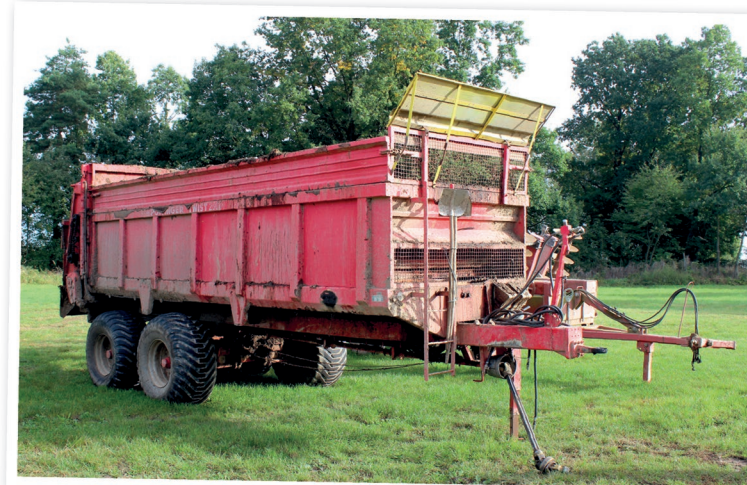
Rozmetadlo Pöttinger TWIST 20001 K2.2 se v ZOD Čičenice využívá jak k aplikaci hnoje, kterou provádí s vysokou rovnoměrností, tak i k dopravě řezanky kukuřice z pole. Je v provozu od roku 2007 a podlahový dopravník má stále originální řetězy
