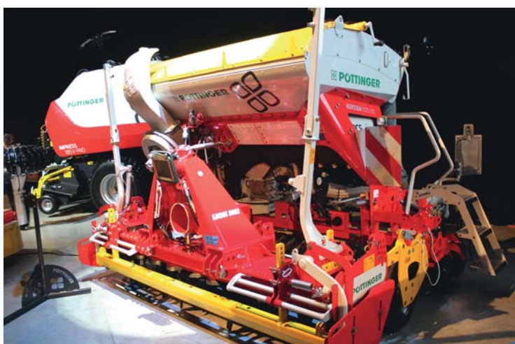
▶ Secí kombinace tvořená rotačními bránami Lion 3002 a univerzálním secím strojem Aerosem 3002 ADD, vybaveným novým výsevním ústrojím Duplex Seed, umožňujícím sít kukuřici do dvojřádků širokých 12,5 cm s roztečí 75 cm
