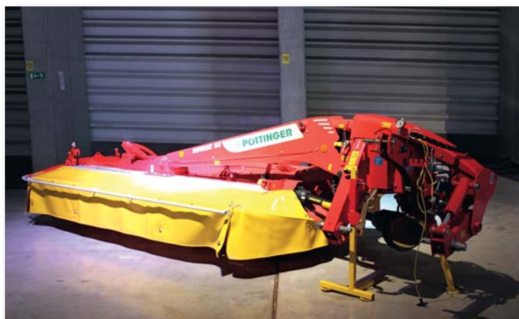
► Žací stroj Novacat 352 CF s pracovním záběrem 3,5 m díky systému Cross Flow v jednom přejezdu poseče a navíc vytvaruje pravidelný řádek
