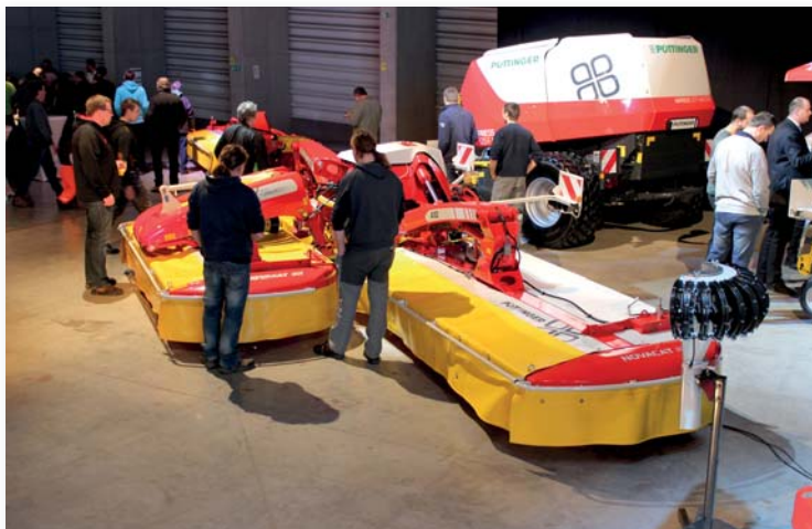
▶ Žací kombinace NOVACAT A10 je vybavena rychloupínáním nožů, Y Drive pohonem nové generace a hydraulickou 3D nájezdovou pojistkou NONSTOP LIFT
