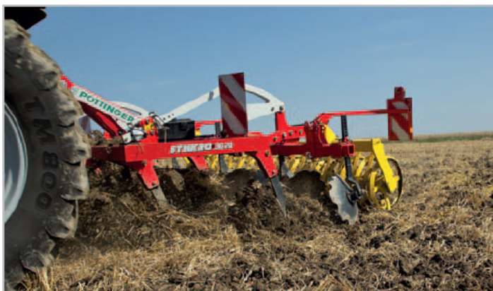
Krátká konstrukce dvounosíkového podmítače řady 1020 umožňuje jeho agregaci s traktory nižších výkonových tříd Foto archiv firmy
