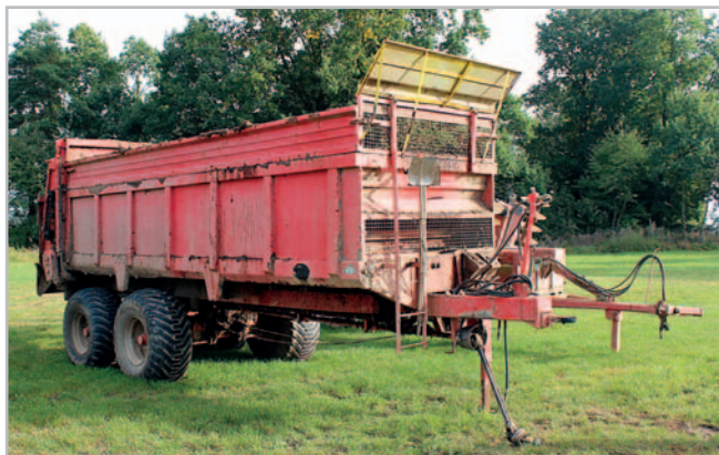
U rozmetadla Twist 20001 K2.2 firmy Pöttinger se v ZOD Čičenice využívá možnosti nasazení jak k aplikaci hnoje, tak i k dopravě řezanky kukuřice z pole. I přes své intenzivní nasazení od roku 2007 má stroj podlahový dopravník stále s originálními řetězy
