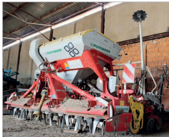
Secí stroj Pöttinger Aerosem 4002 ADD přesvědčil rovnoměrností v podélném rozdělení osiva při seti, které bylo podpořeno ještě účinností rotačních bran Lion 4002 při přípravě půdy. Výhodou je také snadný přístup k zásobníku osiva
