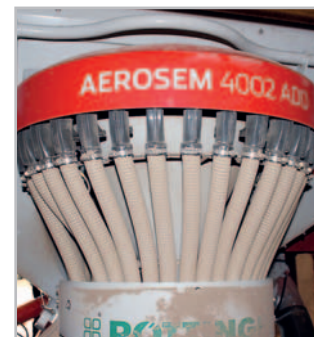
Secí stroj Aerosem 4002 ADD je vybaven standardní rozdělovací hlavicí. Uzavření semenovodů se provádí manuálně po odšroubování krytu a stačí jednoduše přepnout mechanické páčky do polohy zavřeno
