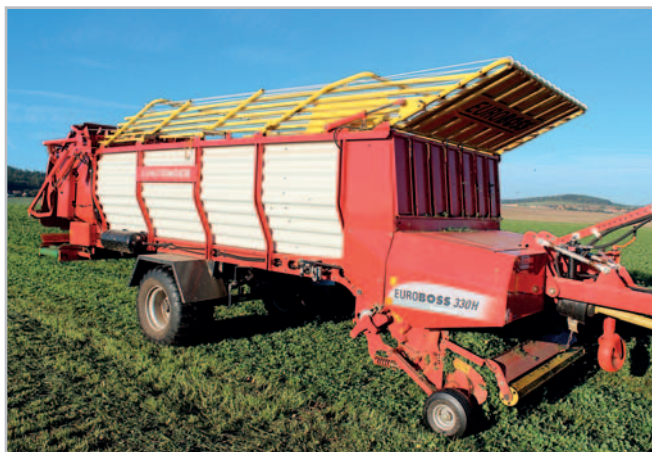
Spokojenost s kvalitou řezanky u návěsů Jumbo vedla Jiřího Stupku k pořízení samosběracího návěsu Euroboss 330 DH. Čerstvou píci tento vůz zpracovává svým řezacím ústrojím s patnácti noži v jedné řadě a do žlabu dopraví pomocí základacího dopravníku
