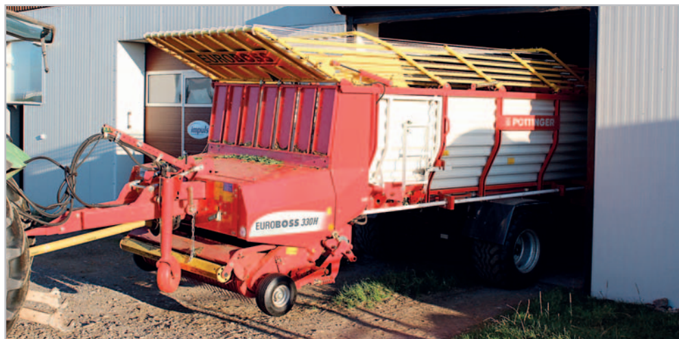
Šikové řešení samosběracích návěsů Euroboss T/H firmy Pöttinger spočívá v tom, že nástavbu na suchou hmotu lze pomocí hydrauliky traktoru sklopit, čímž se získá malá průjezdní výška vozu. Ten pak může projíždět i vjezdy s omezenou výškou
