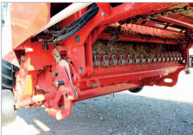
Výskyt kamenů ve sklizené hmotě eliminuje originální systém jistění nožů ve dvou bodech. Malé nečistoty propadnou zpátky na strniště, při pohybu větších kamenů dovoří jistění nožů výkyv bez jejich poškození
