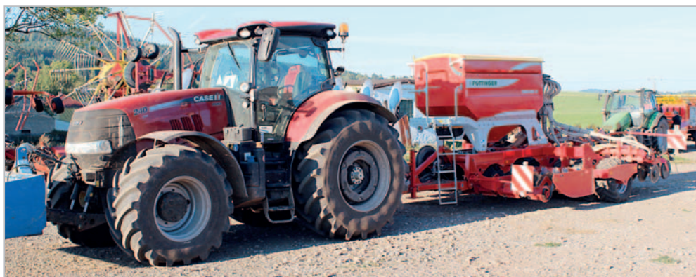
Velký objem zásobníku osiva, vyšší pracovní rychlost a tím i vysoká výkonnost při zakládání porostů jsou hlavní výhody univerzálního secího stroje Terrasem R4, který na farmě Jiřího Stupky pracuje od roku 2016. Stroj se ovládá prostřednictvím ISOBUS na terminálu AFS Pro 600 traktoru Case IH Puma 240 CVX
