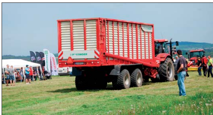
Senážny voz Jumbo 7210 combine, vybavený aj automatickou brúskou nožov Autocut.
