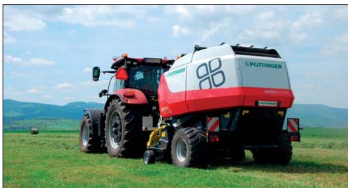
Lis Impress je možné vybaviť pevnou alebo variabilnou lisovacou komorou. Na snímke v agregácii s traktorom Puma 240 CVX.
