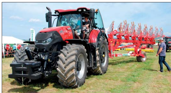
Case IH vyrába modely Optum v dvoch prevedeniach: 270 a 300. Na snímke silnejšia verzia s pluhom Pöttinger Servo 6.50.
