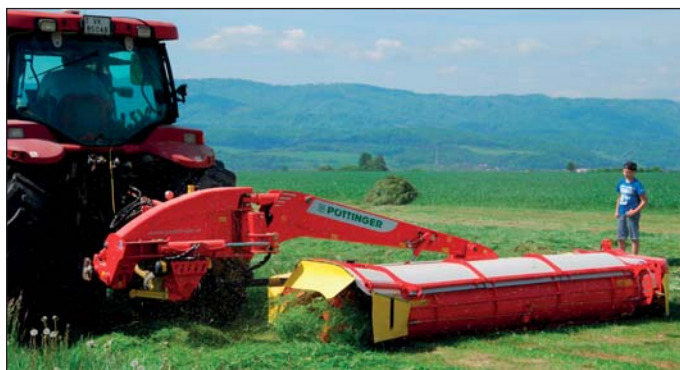
Disková kosa Novacat 352 CF so šnekovým dopravníkom, ktorý zhadzuje pokosenú hmotu do riadku.
