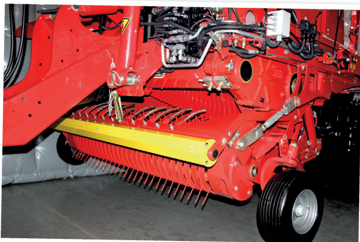
Šestiradý sběrač přesvědčil v testu svou kvalitou práce, a to i při vyšších jezdových rychlostech. Přídavný senzor na oji umí zajistit automatické srovnání návěsu do vodorovné polohy v případě, že je sběrač delší dobu ve zdvižené poloze
