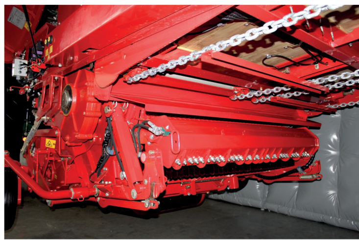
Návěsy Europrofi 5010 Combline mají plnicí spirálový rotor poháněný prostřednictvím velkoryse dimenzované převodovky s ozubenými koly. Kromě výměny oleje je bezúdržbová
