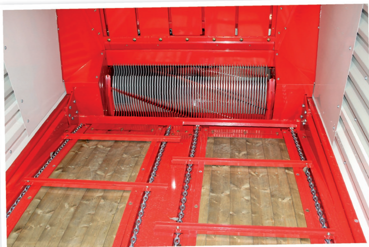
Podlahový dopravník je v přední části vozu skloněný dolů, takže plnění píce může probíhat snadněji. Hmotu dopravují prsty rotoru s malou šířkou skrze stěrky se šířkou větší, čímž je mimo jiné zaručeno šetrné zacházení s krmivem
