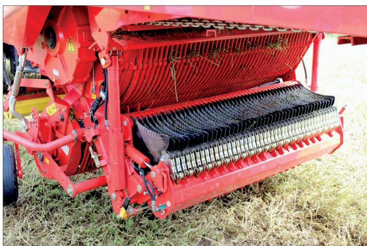
**Vyklopení nosníku nožů se ovládá pomocí tlačítka na boku, stejně jako následné hydraulické odjištění. Poté lze nosník manuálně vyklopit do strany a nože s oboustranným ostřím stačí pouze otočit. Tím se při dlouhých pracovních dnech šetří čas, zároveň není nutné vozit s sebou v traktoru druhou sadu nožů**
