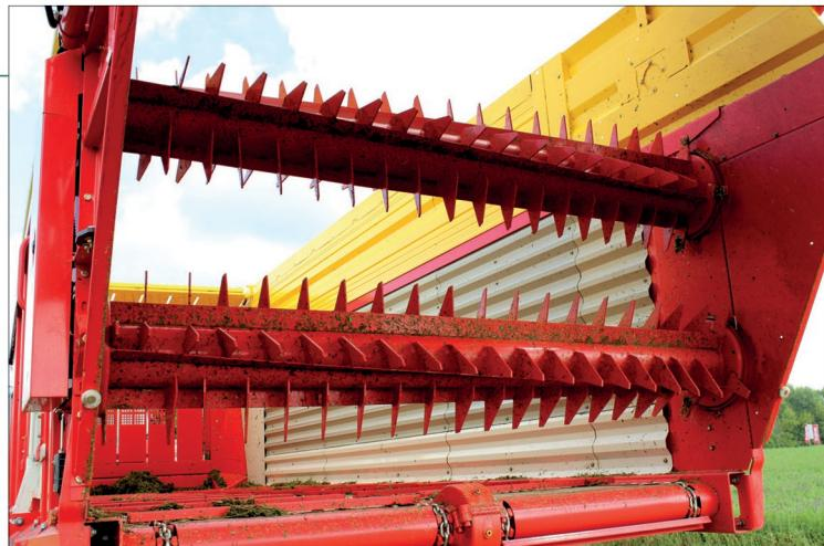
**Sepnutí pohonu rozdružovacích válců je řízeno automatikou vyprazdňování. Hmotu k nim posouvá dvourychlostní podlahový dopravník se čtyřmi řetězy. Od spodního rozdružovacího válce je zapínáno hlášení o naplnění ložné plochy**
