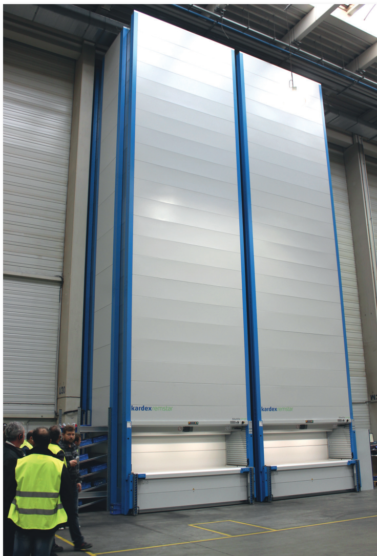
► Výškový základací systém dokáže na velmi malé ploše uskladnit až 65 t materiálu
