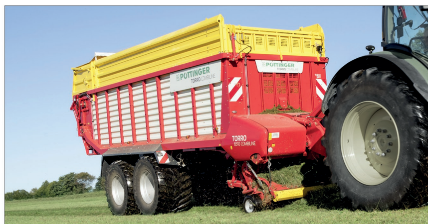
Pro senážní a víceúčelové návěsy Torro a Jumbo má firma Pöttinger nově v nabídce nízkotlaké pneumatiky Flotation Trac značky Vredestein o rozměru 800/45 R 26,5". Osvědčený dezén působí šetrně na travní drn a má zároveň i velmi dobré samočisticí schopnosti, takže se půda nevynáší na vozovku
