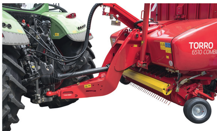
Oj návěsů Pöttinger je konstruována tak, aby její štíhlý tvar dovoloval velké natočení traktoru vůči vozu. Od roku 2017 bude mít oj kapacitu pro svislé zatížení 3000 kg, což pro praxi znamená, že nejvyšší celková dovolená hmotnost návěsu vzroste o 1000 kg
