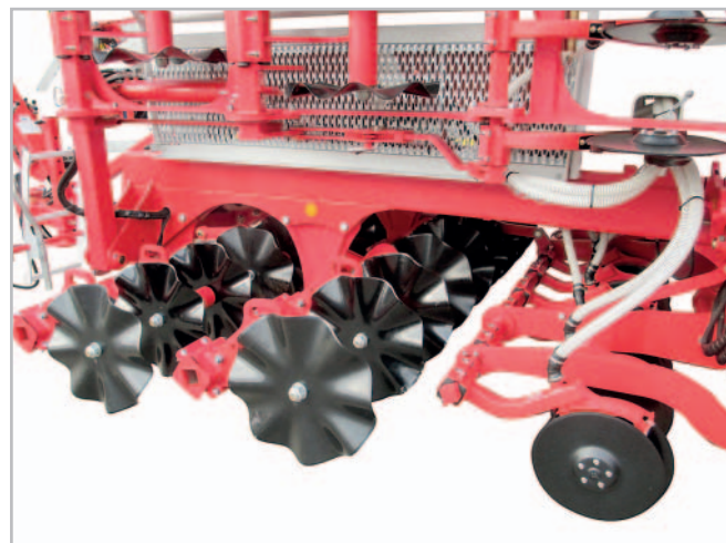
Systém Wave disc je tvořen talíři o průměru 510 mm v rozteči 12,5 nebo 16,7 cm. Přítlak na každý talíř může činit až 100 kg
