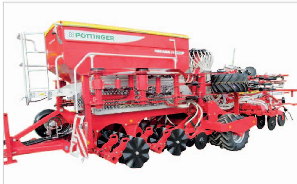
Firma Pöttinger představila druhou variantu předřazené půdozpracující sekce pro své pneumatické secí stroje Terrasem R/C – dvě řady zvlněných talířů Wave disc. Talíře nemají svislé zaúhlení a provádí kypření půdy v pruzích o šířce zhruba 50 mm
