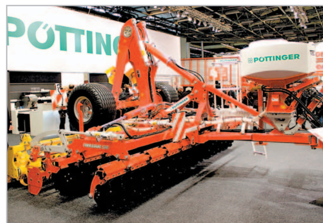
Talířový podmičák Terradisc 5001 T byl vybavený segmentovým opěrným válcem Tandem Conoroll, vhodným pro práci na půdách s vyšším podílem rostlinných zbytků na povrchu, a secím strojem Tegosem 500 pro seti meziplodin
