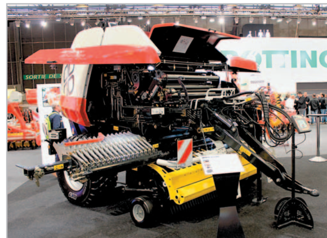
Svinovací lisy Impress s variabilní či pevnou komorou dokážou sklízet krmivo tak, že řezanka má teoretickou délku 36 mm. Díky novému systému dopravy hmoty do komory se současně snižují ztráty cenných částí rostlin
