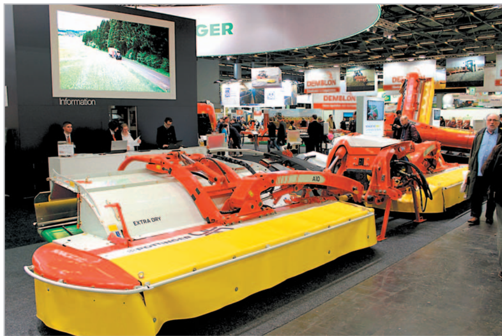
Nová konstrukce pohonu u žací kombinace NovaCat A10 zajišťuje klidnější chod při zvýšené výkonnosti a prodloužení životnosti
