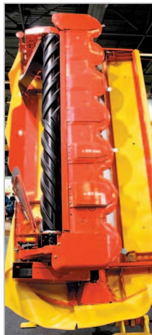
Nový válcový mačkač NovaCat RCB je poháněn ozubeným řemenem. Horní válec má možnost většího výkyvu, zároveň má toto zařízení i zvýšenou účinnost v úpravě hmoty. Vystavený stroj NovaCat 302 RCB prezentoval dvě provedení zvýšených plazů pro zvýšení o 20, respektive o 40 mm
