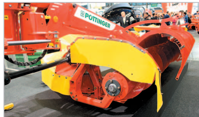
Přičný šnekový dopravník u žacího stroje NovaCat 352 CF odebrává hmotu rovnu od žacích disků a bez dotyku s půdou ji včetně listků přičně přesouvá až k řádku, odloženému mezi koly traktoru čelně neseným žacím strojem
