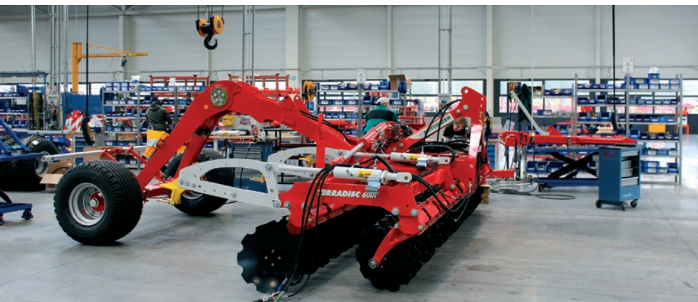
Polonesený talířový podmičák TERRADISC 6001 T, který lze na přání vybavit i secím strojem TEGOSEM 500 pro výsev meziplodin. Zpracování půdy a setí meziplodin při jedné pracovní operaci – úspora času i nákladů.
