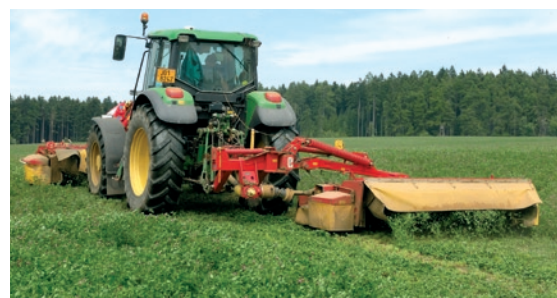
Žací kombinace čelní žací lišty NOVACAT 301 F ED alpha motion a zadní lišty NOVACAT 305 H ED, obě s prstovým lamačem EXTRA DRY.
