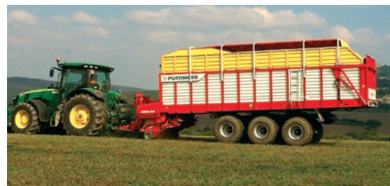
Senážny voz JUMBO 8010 L s nápravou TRIDEM, ktorá nezávislým uložením náprav a hydro pneumatickým odpružením poskytuje vozu maximálnu stabilitu.
