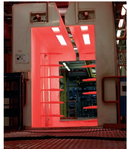
Moderní prášková katarforézní lakovna zabírá plochu 6 000 m 2 a kvalitou je srovnatelná s lakovnami v automobilovém průmyslu.
