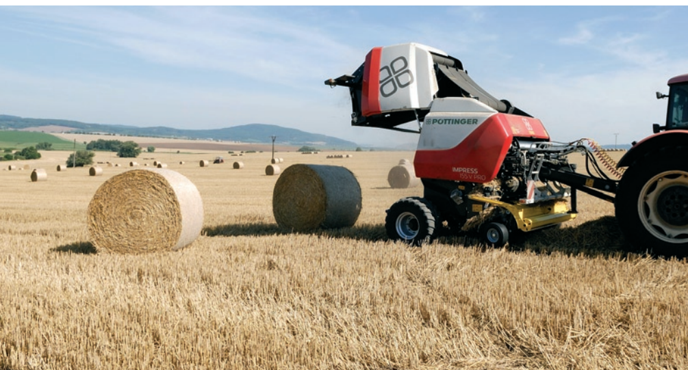
Lis s variabilní komorou IMPRESS 155 V PRO zpracovává hmotu do balíků o průměru 0,80 až 1,55 metru. Balíky dokáže slisovat do dokonalého tvaru.
