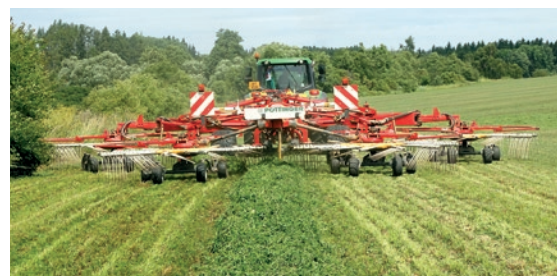
Čtyřrotorový shrnovač TOP 1252 pro tvorbu středového řádku má pracovní záběr až 12,5 metru.
