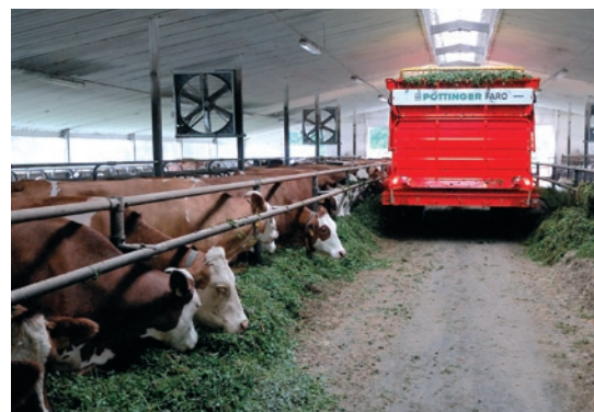
Výkonná souprava žacího stroje NOVACAT 261 classic se samosběracím vozem FARO 4010 D zvládne píci rychle sklízet z pole a poté ve stáji založit do žlabu.
