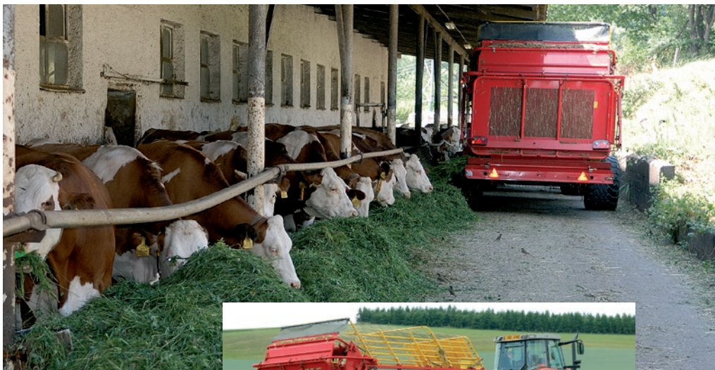
Samosběrací vůz EUROBOSS 330 TD pracuje v agregaci s traktorem 120 k. Dojnícím naváží zelené krmivo přímo na krmný žlab dvakrát za den od jara do podzimu.
