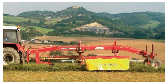
Dvojrotorový zhrňovač EUROTOP 651 zhrňuje maximálne čisto a jeho veľkou výhodou je aj nízka energetická náročnosť.
