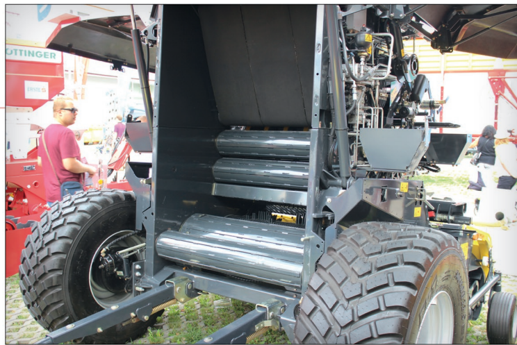
Vhodně připravený exponát lisu dal nahlédnout dovnitř lisovací komory na startovací válce a na trojici širokých nekonečných řemenů. Byl také patrný přímý pohyb hmoty plnicím ústrojím do komory
