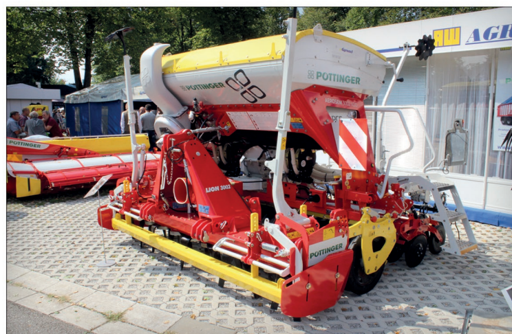
Pneumatický secí stroj Aerosem ADD v provedení se systémem PSC a hlavici IDS umožňuje nejen klasické úzkorádkové seti, ale také přesné seti řepky či zakládání porostů širokorádkových plodin (kukuřice, slunečnice) včetně přihnojování nebo setí podsevu
