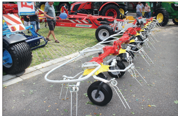
Tažený desetitorový obraceč HIT 10.11 T se i přes svůj záběr 11 m vyznačuje pečlivým kopírováním terénu a rychlým a bezproblémovým skládáním do transportní polohy při přesunech mezi pozemky
