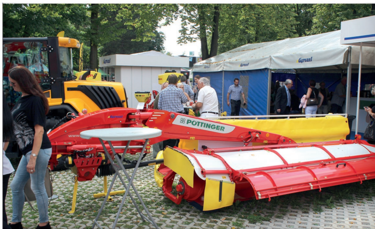
Nesený žací stroj NovaCat 352 Cross Flow dovoluje bezeztrátovou sklizeň pícnin tím, že hmota je bezprostředně po posečení posouvána a šetrně odložena na řádek od čelně neseného žacího stroje
