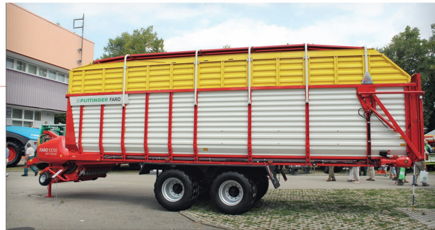
Ve střední třídě samosběracích návěsů představuje firma Pöttinger novou „desítkovou“ řadu vozů Faro. Nový model Faro 10010 pojme až 100 krychlových metrů hmoty při středním stlačení
