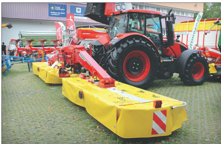
Vysoká výkonnost na úrovni 11 ha/h při nízké energetické náročnosti, to jsou devízy žací kombinace NovaCat S10. Kopírování terénu je umožněno středovým zavěšením žacích strojů a plynule nastavitelným hydraulickým odlehčením
