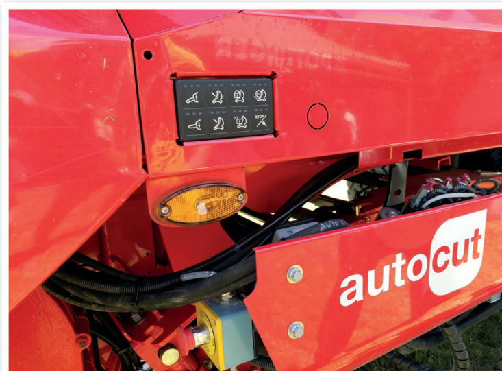
Boční ovládací pole s novou ovládací platformou prostřednictvím CAN-Bus systému nabízí dobrý přehled všech přídatných funkcí
