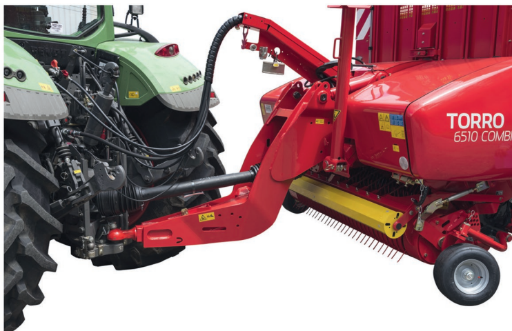
Dosavadní provedení oje se zatížením 3000 kg (na obrázku) bude doplněno novou ojí pro svislá zatížení až 4000 kg. Nebude chybět ani elektronické nucené řízení jako součást inteligentní nápravy
