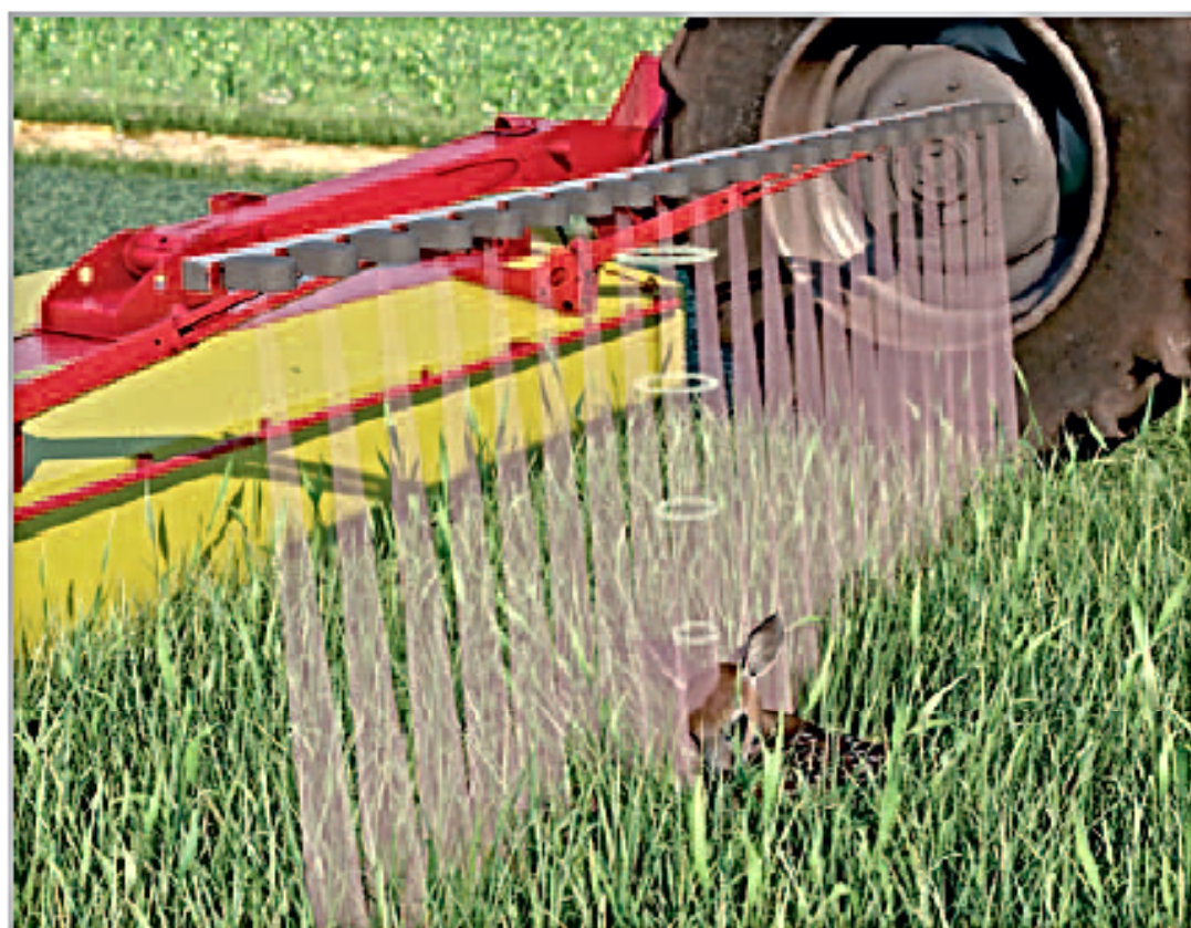
Systém Sensosafe využívá optický senzor k identifikaci výskytu zvěře v porostech píce
