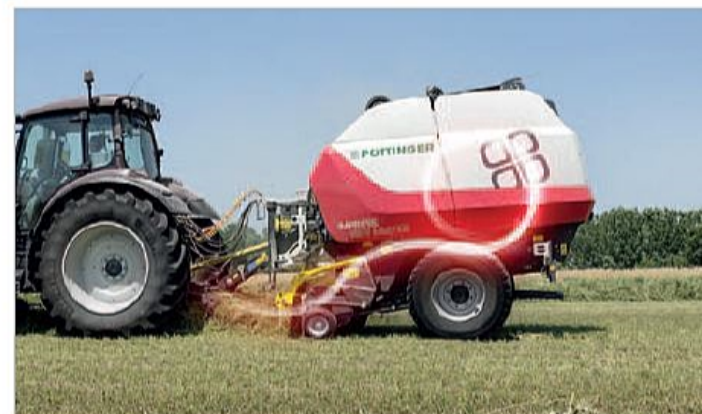
Plnicí rotor Liftup s horním plněním pro přirozený tok píce a nízkou energetickou náročnost Foto archiv firmy
