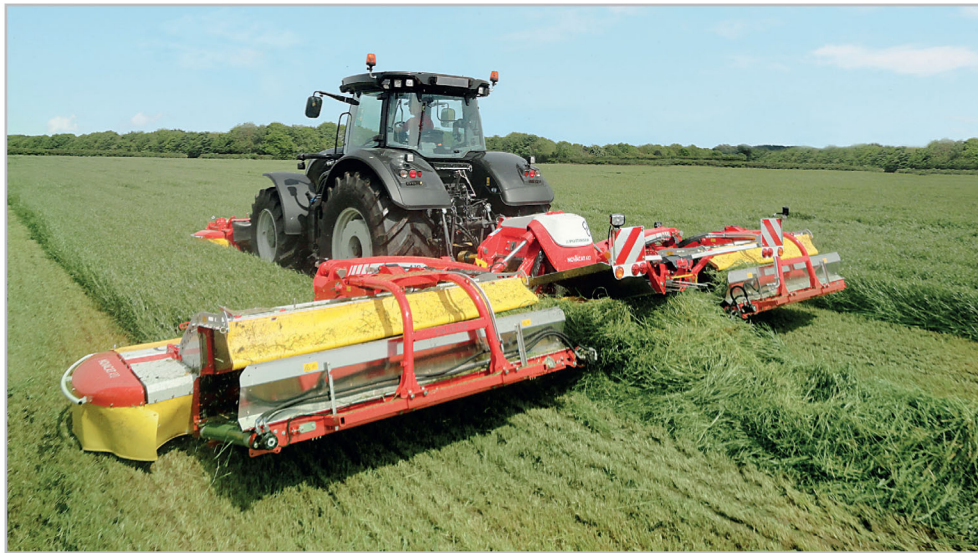
Charakteristickým znakem žacích kombinací je stavebnicová konstrukce – zařízení pro úpravu pokosu nebo shazovací pásy jsou velmi snadno demontovatelné
