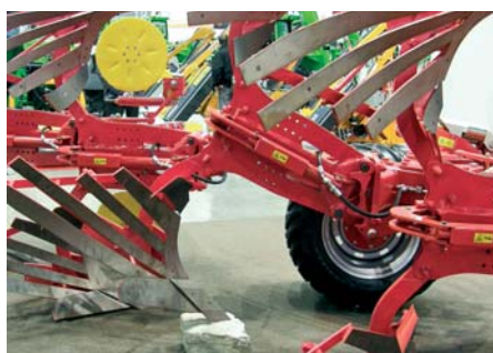
Detailný pohľad na orbové teleso s hydraulickým istením.
