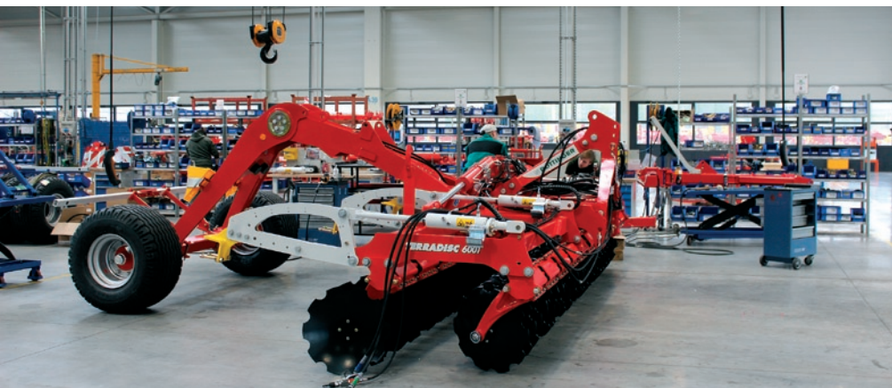
Polonesený talířový podmiťák TERRADISC 6001 T, který lze na přání vybavit i secím strojem TEGOSEM 500 pro výsev meziplodin. Zpracování půdy a setí meziplodin při jedné pracovní operaci – úspora času i nákladů.
