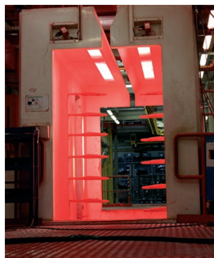
Moderní prášková katarforézní lakovna zabírá plochu 6 000 m 2 a kvalitou je srovnatelná s lakovnami v automobilovém průmyslu.
