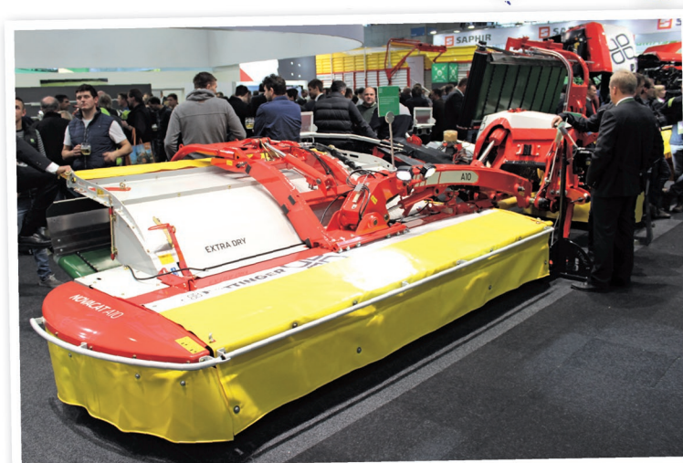
Žací kombinace NovaCat A10 byla na veletrhu Agritechnica prezentována v provedení s pásovými dopravníky Collector. Dopravníky je také možné kdykoli demontovat, například pro vysekávání pastvin, a na jaře pak opět připojit. Práci dopravníků mohou dále „perfekcionalizovat“ nové automatické funkce
