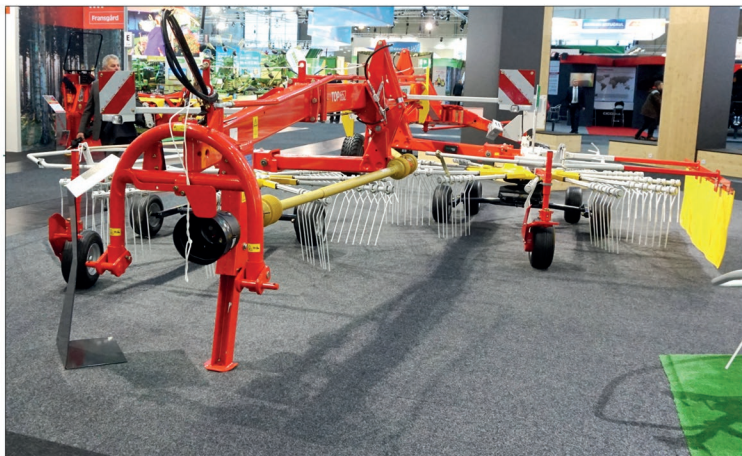
Nový typ dvourotorového shrnovače TOP 652 je nástupcem legendárního stranového shrnovače Eurotop 651. Osazen je rotory nové generace Toptech Plus s velkým počtem hrabíc a aktivně pracujícím pětikolovým podvozkem
