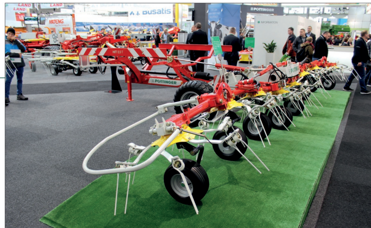
Velice úspěšné tažené obraceče firmy Pöttinger s vlastním podvozkem mají nový přírůstek v podobě osmirotorového obraceče HIT 8.9 T – kompaktní model se záběrem 8,86 m. Samostatné uložení rotorů dovoluje plynulé kopírování terénu
