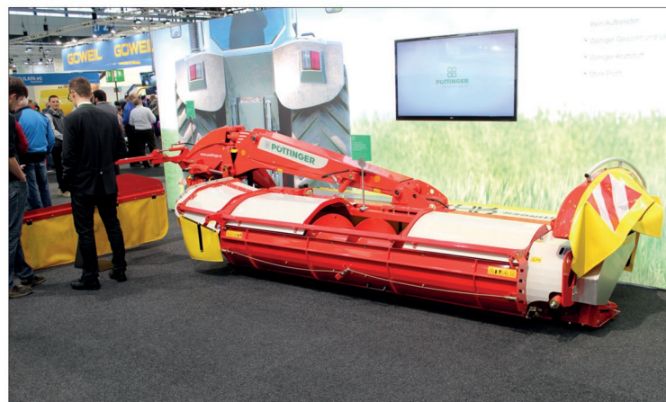
Se žacím strojem NovaCat 352 CF nabízí firma Pöttinger možnost shazování pokosu na jeden řádek od dvou nesených žacích strojů při jedné jízdě
