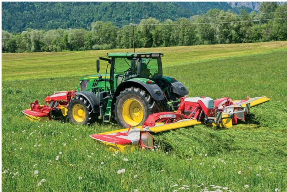
NOVACAT A 10 – nastaviteľný pracovný záber i v priebehu práce.
