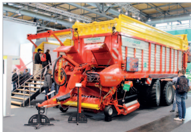
Torro 8010 D Combiline je nový největší model víceúčelových návěsů střední třídy Torro Combiline. Podvozek Tridem měl nucené řízení první a třetí nápravy a zvedatelnou první nápravu. Zajímavě byl prezentován příčný výkvy sběrače, výkvyvý nosník nožů Easy Move s noži Twinblade a brousicí zařízení Autocut
