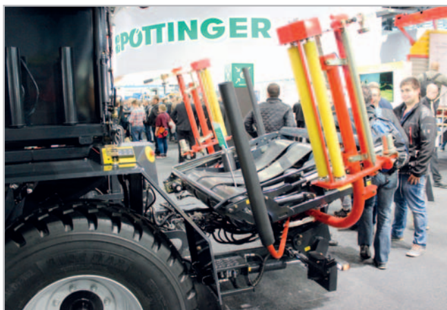
Ovíječka má vysoký stupeň všestrannosti v závislosti na průměru balíků (od 1,1 do 1,5 m) a požadovaném počtu ovinutí i překrytí fólie. Pro ovinutí slouží dvě ramena s 36 otáčkami za minutu se spodním uložením, u nichž je výměna rolí fólie jednoduchá díky jejich nízké výšce
