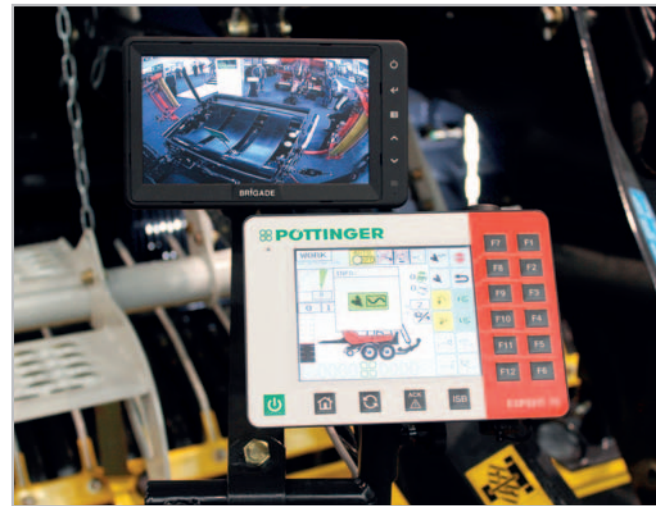
Nový terminál Expert 75 firmy Pöttinger má kromě barevné obrazovky ještě ovládací lištu tlačítek, na níž lze stroj jednoduše ovládat pravou rukou. Terminál lze umístit na různá místa v kabině, případně doplnit terminálem pro výstup kamery jako u kombinace lisu s ovíječkou na jednom podvozku Impress 155 VC Pro
