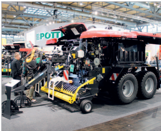
K výhodám kombinace lisu Impress 155 VC Pro s ovíječkou patří také to, že balík je po ovázání ihned ovinutý fólií. Řezací ústrojí s 32 noži dokáže zkrátit píci na velmi malou délku, což dovoluje vysokou úroveň slisovanosti a vytěsnění vzduchu
