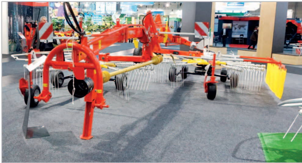
Nový typ dvourotorového shrnovače TOP 652 je nástupcem legendárního stranového shrnovače Eurotop 651. Je osazen rotory nové generace Toptech Plus s velkým počtem hrabic a aktivně pracujícím pětikolovým podvozkem
